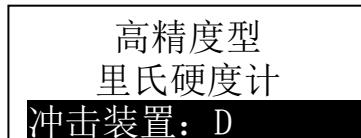
仪器会检测冲击装置类型并显示，此步骤请仔细观察是否正确，然后进入测量主显示界面。
