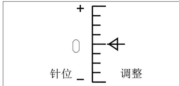
在主界面状态下，按
