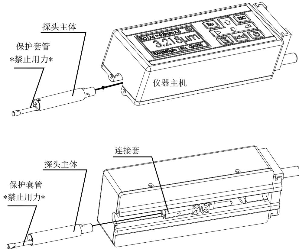
安装时，用手拿住**探头主体**部分，按图所示将探头插入仪器底部的传感器连接套中，然后，**ESC**轻推到底。拆卸时，用手拿住传感器的**探头主体**部分或保护套管的根部，慢慢地向外拉出。
